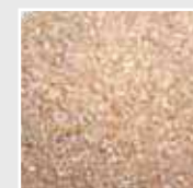
Verunreinigungen im Kristallgitter verfärben den Quarzsand (rot/braun) Impurities in the crystal lattice can discolour the quartz sand (red/brown)
